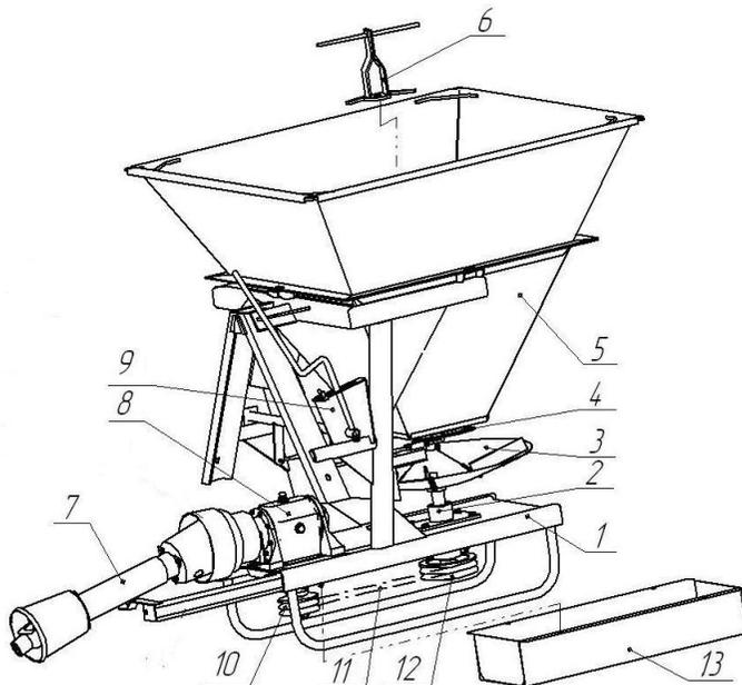
1- рама 116.00.010; 2 - опора 116.00.040; 3- диск рассеивающий 116.00.467; 4- устройство дозирующее; 5- бункер загрузочный 116.00.020; 6 - ворошитель 116.00.310; 7- Вал телескопический 116.00.090; 8 - редуктор РН 090.20.000-213; 9 - механизм управления заслонками; 10 – шкив 116.00.101-01; 11 – ремень А-1400 ГОСТ 1284.1-89; 12 - шкив 116.00.102-01; 13 – ограждение 116.00.080
