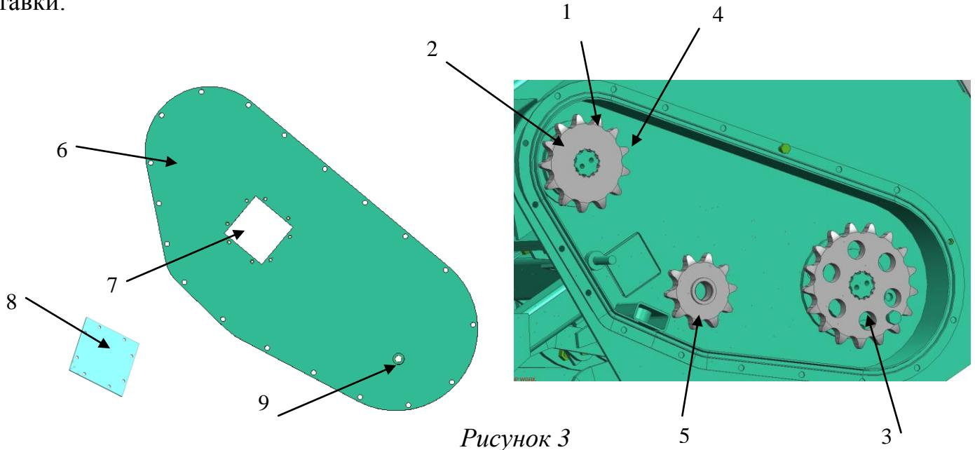
2.1.3 Бортовая передача в соответствии с рисунком 3 состоит из: корпуса – 1; звездочек: ведущей – 2 и ведомой – 3; цепи  $t = 44,45$  – 4; натяжителя – 5; закрыта крышкой – 6; смотрового окна – 7 одновременно являющегося заливной горловиной для заправки маслом с крышкой – 8; контрольного отверстия – 9, закрытого пробкой и указывающего требуемый уровень масла.
