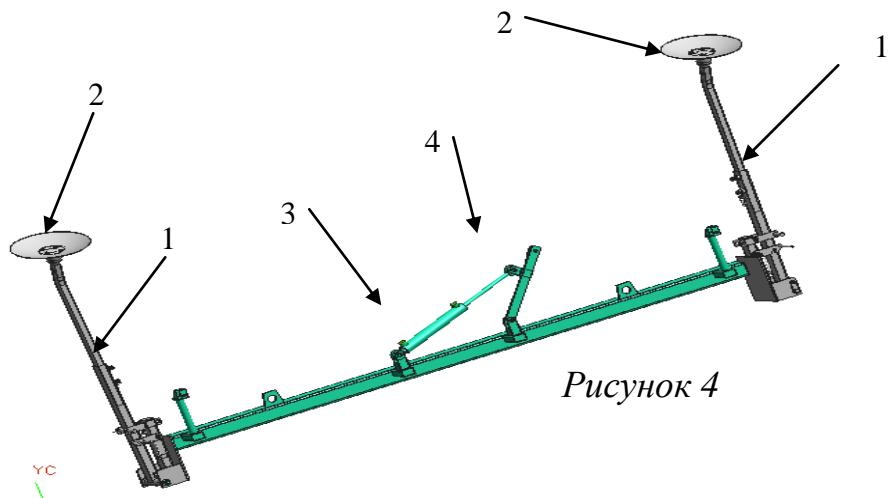
2.1.4 Маркеры гидрофицированные состоят из телескопических штанг –1, дисков со ступицами –2, гидроцилиндра –3, кронштейна для крепления тросиков –4.
